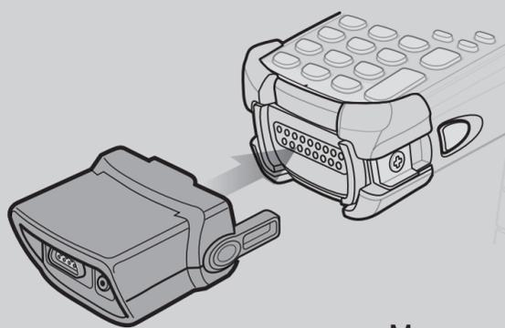
Модуль подключения кабелей
