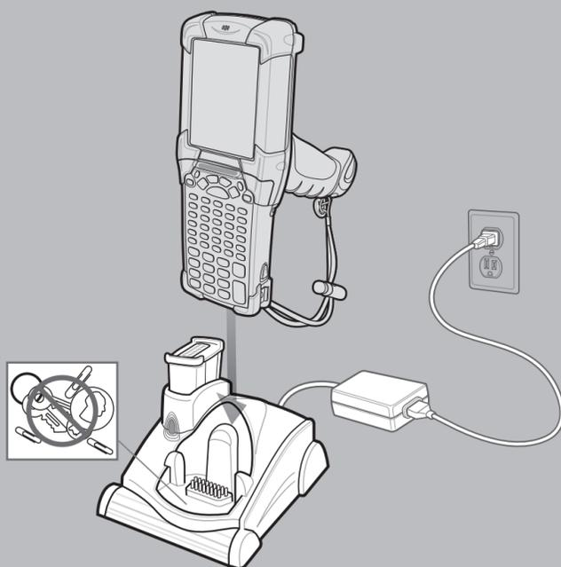
Базовая станция с одним гнездом и последовательным/USB-портом
