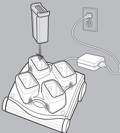
Зарядное устройство для четырех резервных аккумуляторов
