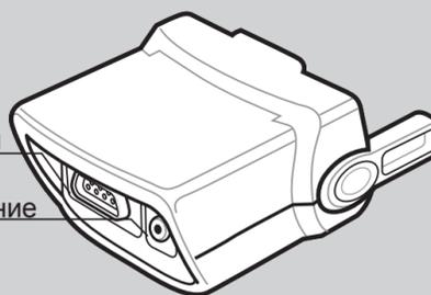
Устройство чтения кодов на магнитных полосах
